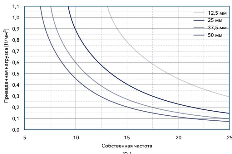
Собственная частота системы с одной степенью свободы, состоящей из постоянной массы и эластичного слоя Вибролок SD 650 на жесткой подоснове
