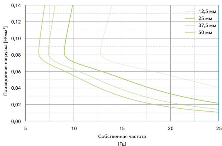
Собственная частота системы с одной степенью свободы, состоящей из постоянной массы и эластичного слоя Вибролок SD 65 на жесткой подоснове
