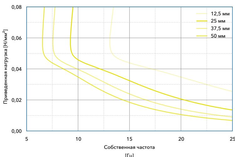
Собственная частота системы с одной степенью свободы, состоящей из постоянной массы и эластичного слоя Вибролок SD 40 на жесткой подоснове
