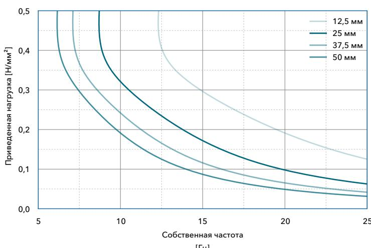
Собственная частота системы с одной степенью свободы, состоящей из постоянной массы и эластичного слоя Вибролок SD 260 на жесткой подоснове
