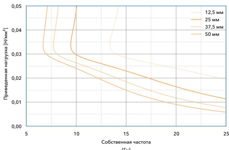
Собственная частота системы с одной степенью свободы, состоящей из постоянной массы и эластичного слоя Вибролок SD 26 на жесткой подоснове
