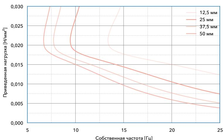
Собственная частота системы с одной степенью свободы, состоящей из постоянной массы и эластичного слоя Вибролок SD 16 на жесткой подоснове
