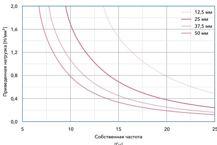
Собственная частота системы с одной степенью свободы, состоящей из постоянной массы и эластичного слоя Вибролок SD 1300 на жесткой подоснове
