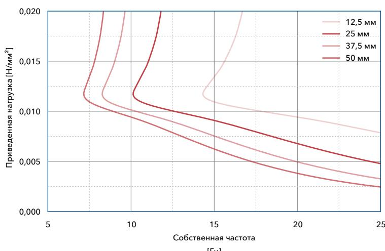
Собственная частота системы с одной степенью свободы, состоящей из постоянной массы и эластичного слоя Вибролок SD 10 на жесткой подоснове
